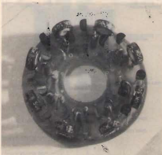
Il circuito dell'interruttore "esclusivo" a montaggio ultimato.
