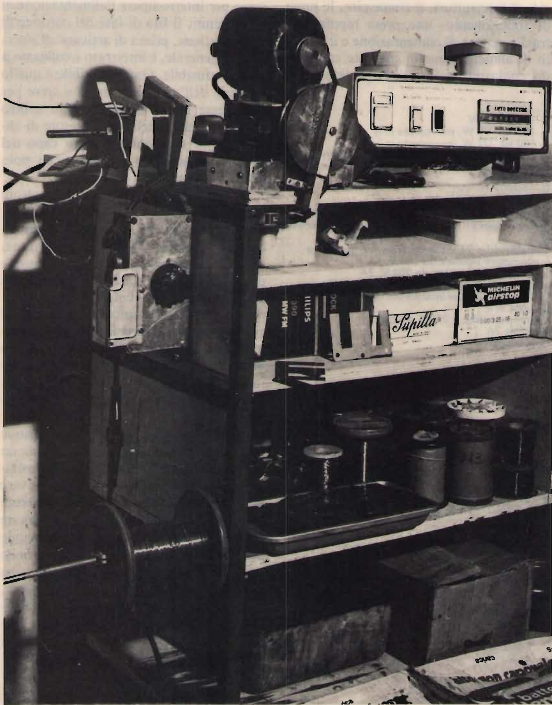
Bobinatrice in funzione.
